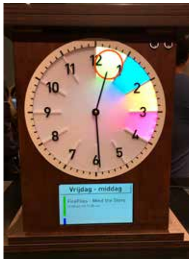
Studentenprojekt macht aus Vertrautem ein neues Werkzeug: Eine Uhr, die dementen Personen nicht nur sagt, dass es halb eins ist, sondern auch dass es Freitag Mittag ist und was jetzt auf dem Tagesprogramm steht. Projekt: Wijstijd von Tilly Coppelmans, Industrial Design, Eindhoven. University of Technology
